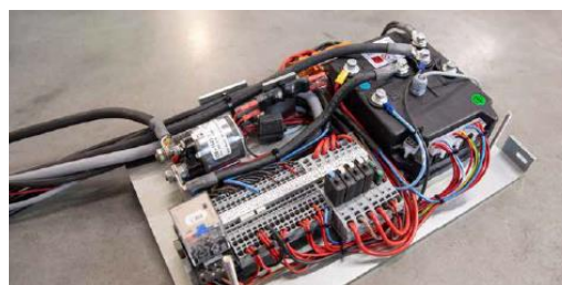
ACX elektronika, umožňuje sieťové pripojenie rôznych funkcií, riadi prevádzkové stavy ako sú mäkký štart kief a sania ako aj ovládanie GWS
