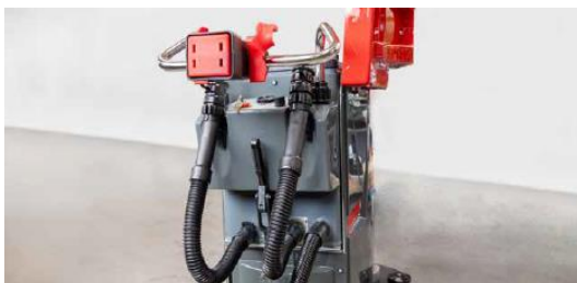
Vypúšťacia a sacia hadica vyrobené s vysoko flexibilného PU s mäkkou zónou zalomenia
