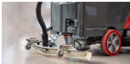
Sacia lišta je vyrobená z nehrdzavejúcej ocele s rýchlo upínacím systémom
