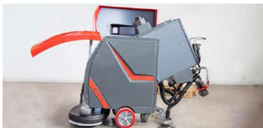
Vyklápací tank umožňuje rýchly prístup k batériám a efektívnejšie vyprázdenie špinavej vody
